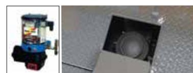
Système de graissage automatique
