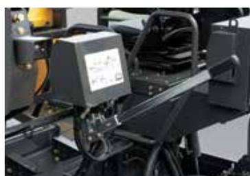
\* La pompe à main hydraulique peut actionner les cylindres de la trémie, l'extension et le levage de la plaque.
